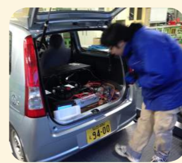
バッテリーが積まれEVコンバートされた車
